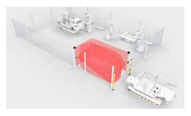
Lösung: Eine Sicherheitsschleuse ist an drei Seite durch optoelektronische Sicherheitssensoren begrenzt. So kann der Fahrweg des FTS in Richtung Gefährdungsbereichs frei gewählt werden. Sicherheits-Radarsensoren prüfen den inneren Bereich der Schleuse auf die Anwesenheit von Personen. Nach entsprechender Freigabe kann das FTS seine Fahrt fortsetzen.
